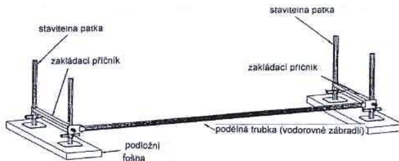
Obr. 2: Vyrovnání nejspodnější úrovně lešení pomocí základacího příčníku a podélné trubky
